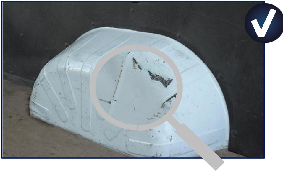
DESGASTE NORMAL: Painel de revestimento da porta de carga em bom estado.
